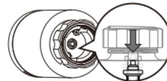
3 Installieren Sie den Thermostat mit M30\*1,5-Gewinde Schnittstelle des Ventils. Ziehen Sie den Kunststoffring fest.
